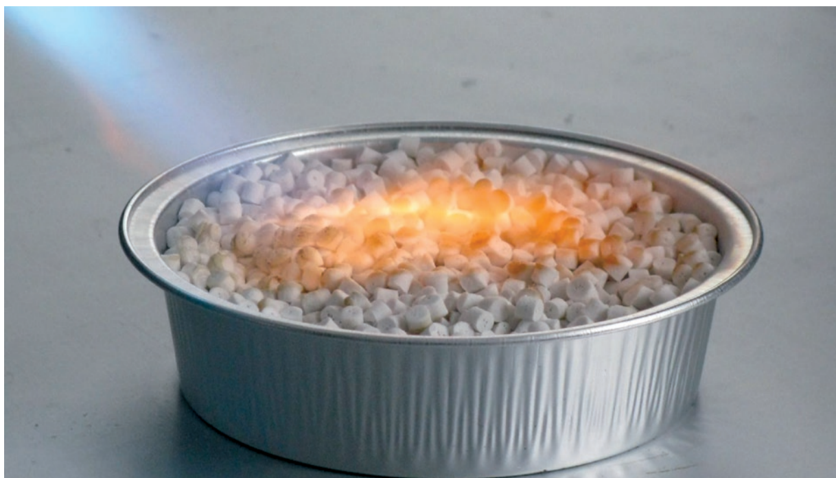
Auswirkung einer heißen Flamme auf flammgeschütztes PE
