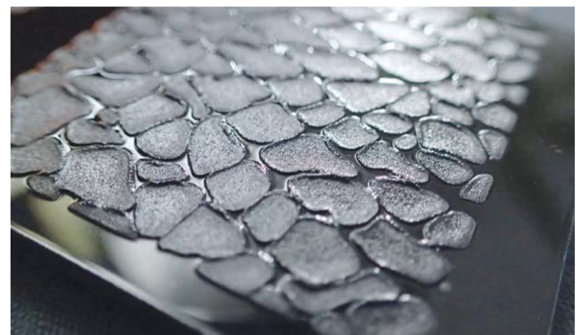
Per Laser nachträglich aufgebraute Oberflächentextur
