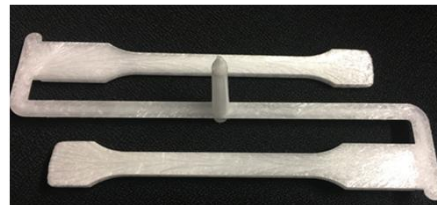
Bild Kunststoff-Institut: Teilfüllung eines geschäumten Prüfkörpers
